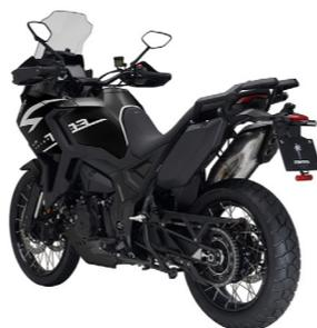
Equipaggiata con un motore 3 cilindri ad elevato rapporto di compressione 13:1 la Zontes 703F in grado di erogare una potenza 95 CV a 10.000 giri con un consumo di 4,3 l/100 km.
