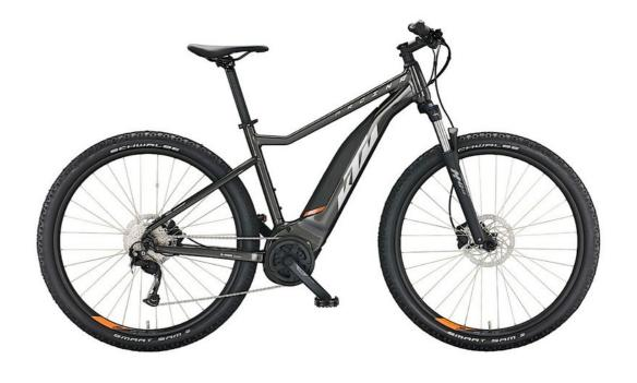
La KTM Macina Ride 591 2022 è caratterizzata dalla potenza del motore BOSCH PERFORMANCE CX, dalla batteria PowerTube da 500Wh e dal telaio UNDECOVER che integra in modo perfetto la batteria all'interno del telaio.
