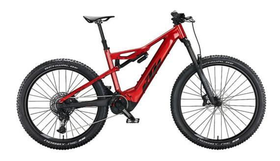
La KTM Macina Kapoho 7973 2022 potrebbe essere la bicicletta perfetta per soddisfare le tue esigenze. Dotata di un telaio in alluminio robusto e di pneumatici collaudati Schwalbe, offre una combinazione ideale di una ruota anteriore da 29" per garantire stabilità durante la guida e pneumatici posteriori da 27,5" PLUS per una trasmissione di potenza e trazione ottimali.
