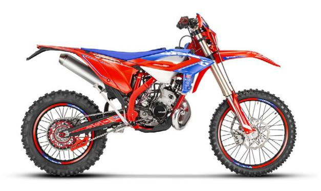
Le Beta RR Racing 2T 200 2023 introducono il monoammortizzatore Kayaba, garantendo un importante miglioramento ciclistico. Presentano componenti racing come il perno ruota anteriore ad estrazione rapida e i paramani rinforzati.
