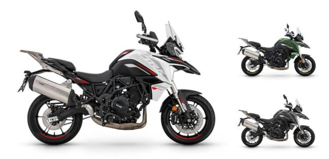
La Benelli TRK 702 è l'ultima creazione versatile e affascinante dell'azienda Benelli. Con il suo nuovo motore bicilindrico da 698 cc che eroga 70 CV di potenza e 70 Nm di coppia, offre un'esperienza di guida reattiva e potente.
