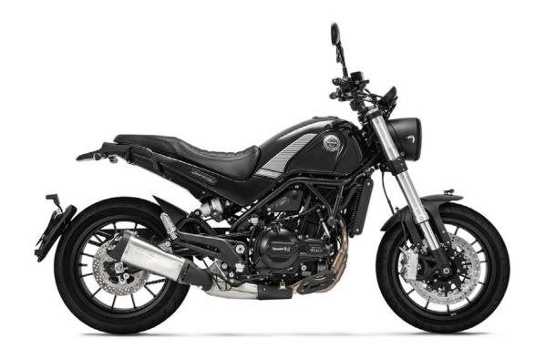
Leoncino 500 2023 è un omaggio ad un'icona dello stile motociclistico italiano. Un mix unico di elementi classici e moderni, questa due ruote incarna storia, tradizione e innovazione. Con un bicilindrico da 500cc raffreddato a liquido, conforme alla normativa Euro 5, offre una potenza di 47,6 CV a 8500 giri/min e una coppia di 46 Nm a 6000 giri/min.
