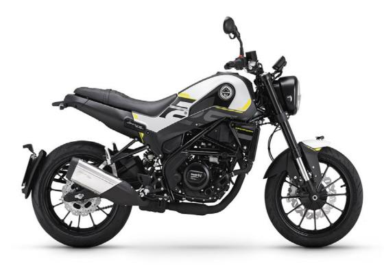
Leoncino 250 2023 è una moto compatta e autentica che unisce il classico al contemporaneo. Equipaggiata con un monocilindrico quattro tempi da 250cc raffreddato a liquido, conforme alla normativa Euro 5, offre una potenza massima di 25,8 CV a 9250 giri/min e una coppia di 21 Nm a 8000 giri/min.
