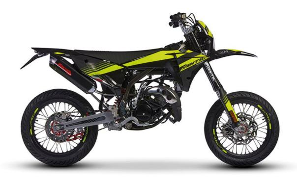
Il Fantic Motard XM 50 Performace 2023 offre prestazioni eccezionali grazie al motore Minarelli 50 2T raffreddato a liquido, combinato con un nuovo scarico e carburatore Dell'Orto. Il motore è conforme alle normative Euro 5 e garantisce un aumento delle prestazioni.
