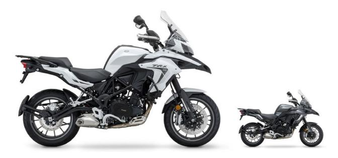
TRK 502 2023 è una bicilindrica Benelli versatile e moderna, con motore da 500cc raffreddato a liquido, conforme alla normativa Euro 5.
